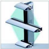
Este sistema, partiendo del Muro invertido, ofrece una estética exterior, en la que en sentido vertical los vidrios ocultan la estructura portante, produciéndose la unión vidrio-vidrio, mientras que en la horizontal, sobre el perfil presor que fija el vidrio se coloca una tapeta, con lo que se resalta enormemente la trama horizontal.
